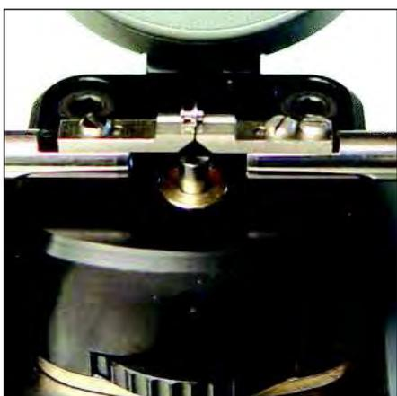
Table avec plateau  $\varnothing$  3 mm à réglage fin. Indication de la hauteur intégré.
