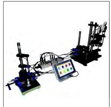
Palpeurs et comparateurs connectàs via des modules M-BUS sur une D400S
