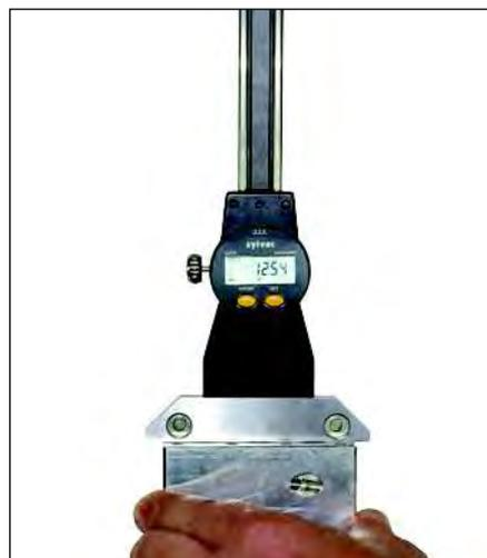
Mesure d'une profondeur
