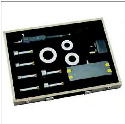
Jeu comprenant 6 t<sup>o</sup>tes de mesure, 3 bagues, 1 D50S, la poign<sup>o</sup>e et son palpeur, le chargeur
