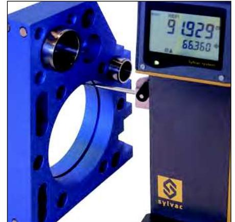
Mesure de diamètre intérieur avec touche bille rubis  $\varnothing$  3 mm, 930.2101 livré en standard
