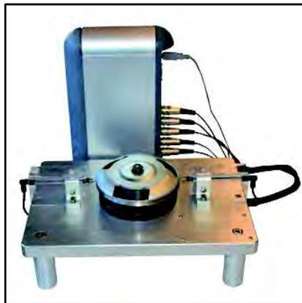
Mesure multi-cotes au moyen d'une D200S avec palpeurs capacitifs
