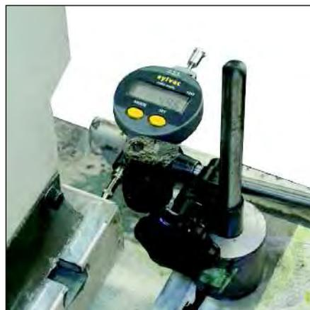
Mesure du déplacement vertical d'un élément
