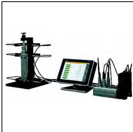
Palpeurs inductifs et Solartron connectés via un module M-bus à une D400S.
