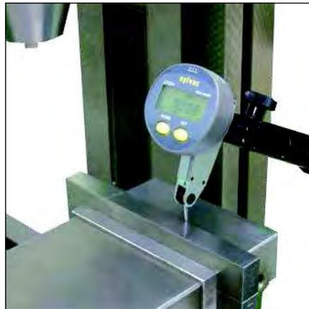
Vérification de l'alignement d'un étau de fraiseuse
