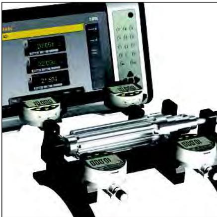
S\_Dial WORK BLUETOOTH® SMART communiquant en duplex avec une unité D300S. Mesure de diamètres extérieurs, concentricité, cylindricité, etc.
