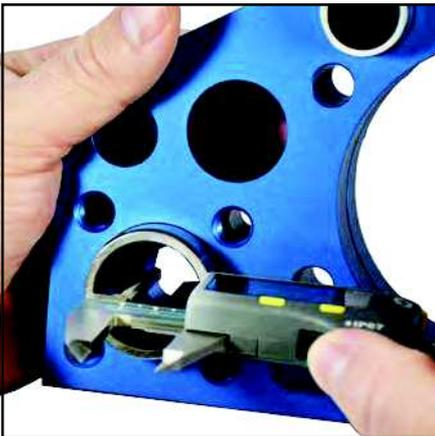
Mesure profonde avec S\_Cal EVO BT DM
